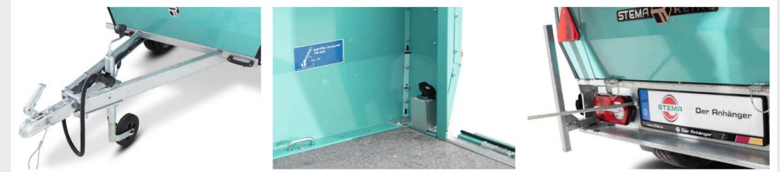
lange Deichsel mit festem Stützrad      12 V KFZ-Steckdose      gut erreichbare Punkte für Ausdrehkurbel mittig links und rechts neben dem Nummernschild
