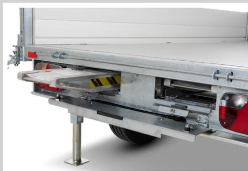
Platzsparendes Feature: Auffahrampen Set praktikabel hinter der Kennzeichenklappe verstaut
