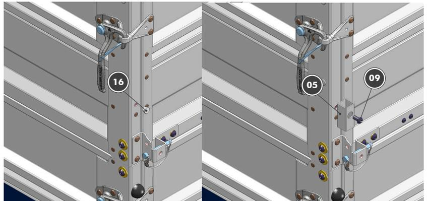
Halten Sie das Aufstellprofil |05| an die vorgesehene Bohrung. Drehen Sie von Außen eine Linsenschraube mit Innensechskant M8x16 |09| und von Innen eine Sechskantmutter M8 |11| in die Bohrung vom Aufstellprofil lose ein.
