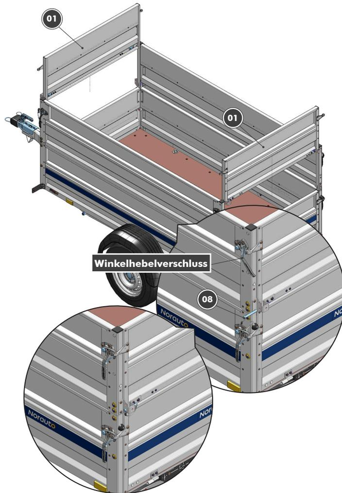
Stecken Sie den Scharnierbolzen |08| in das Scharnier und sichern Sie ihn zusätzlich mit dem Sicherungsbügel
