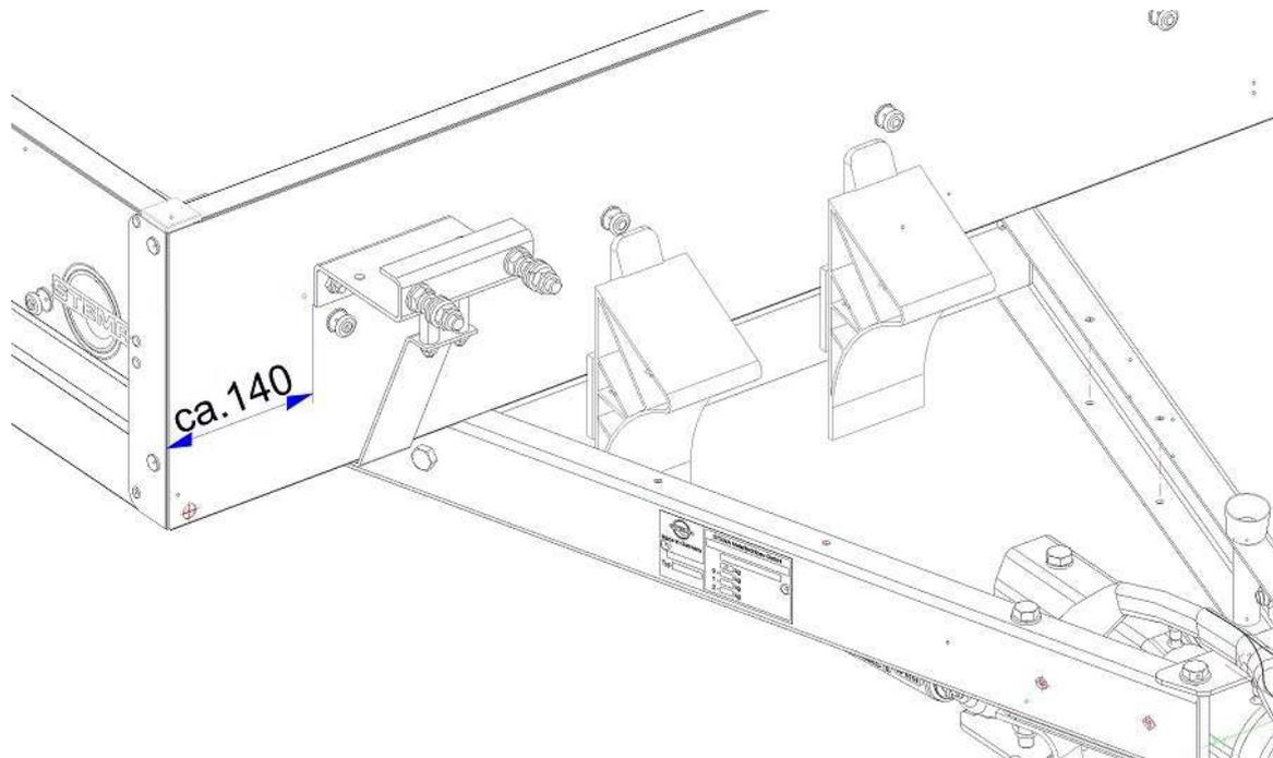
**Skizze des Ersatzradhalters mit den verwendeten Schrauben:**
