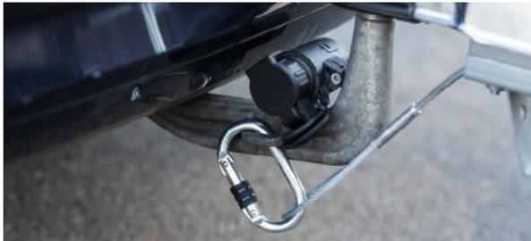
7. Branchez la fiche du câble principal dans la prise du véhicule tracteur. Notez que l'orientation de la fiche de raccordement est mécaniquement pré-déterminée.
