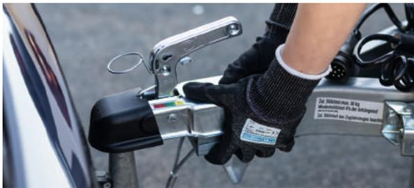
6. En fonction du type de remorque, fixez le câble de rupture ou le câble d'arrêt au véhicule tracteur. Vous trouverez la procédure correcte et de plus amples informations sur les différents câbles dans le chapitre précédent « Câble de rupture et câble d'arrêt ».
