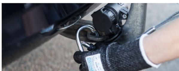
3. Ouvrez le dispositif d'attelage à boule de traction. Tirez le levier d'attelage vers le haut et tournez-le vers l'avant (dans le sens de la marche). L'indicateur de sécurité se trouve dans la zone rouge.<sup>6</sup>
