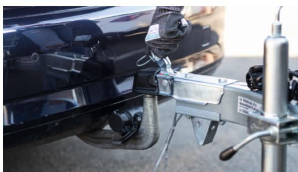
2. Ouvrez le dispositif d'attelage à boule de traction. L'indicateur de sécurité se trouve dans la zone rouge.<sup>5</sup>
