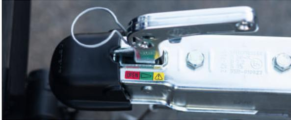
5. Faites un test de levage. La boule de traction ne doit plus se séparer de la tête sphérique.
