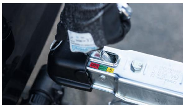
3. Abaissez le dispositif d'attelage à boule de traction jusqu'à enclenchement audible.
