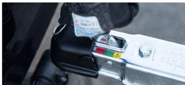
4. Soulevez le dispositif d'attelage à boule de traction de la tête sphérique. Placez le timon sur la béquille. Sur les remorques équipées d'une roue jockey, tournez-la vers le haut à l'aide de la manivelle rotative jusqu'à ce que l'attelage à boule de traction se détache de la tête sphérique et se trouve complètement au-dessus de celle-ci. Déplacez la remorque vers l'arrière à l'écart du véhicule. Placez le timon sur la roue jockey.
