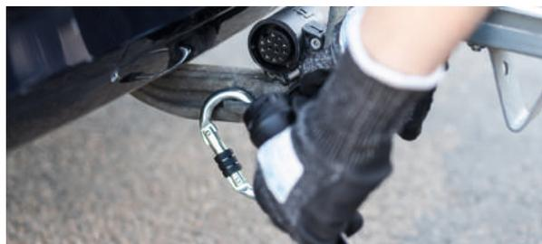
2. Selon la conception de la remorque, détachez le câble de rupture ou le câble d'arrêt du véhicule tracteur et fixez-le correctement à la remorque.
