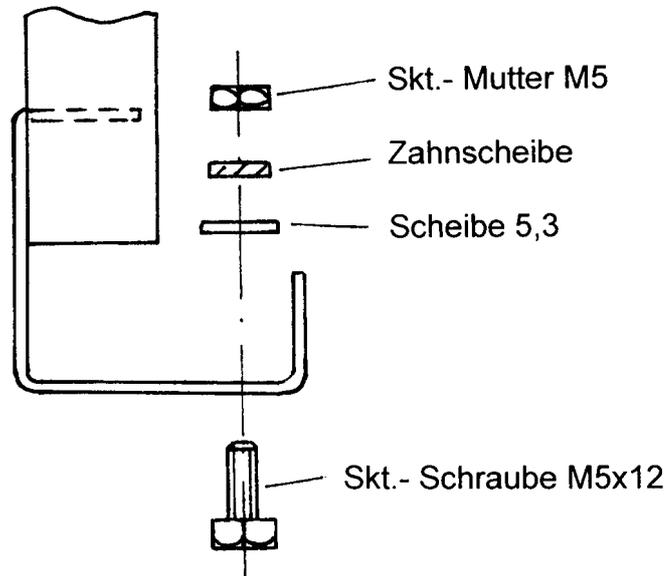
4. Vorderen Bordwandaufsatz auf Vorderwand aufstellen, seitlichen Bordwandaufsatz etwas zur Seite ziehen, so dass die bereits unter Punkt 4 vormontierte Schraube in den seitlichen oberen Schlitz eingreift. Mittlere und untere Schraubverbindung an beiden Seiten montieren.
