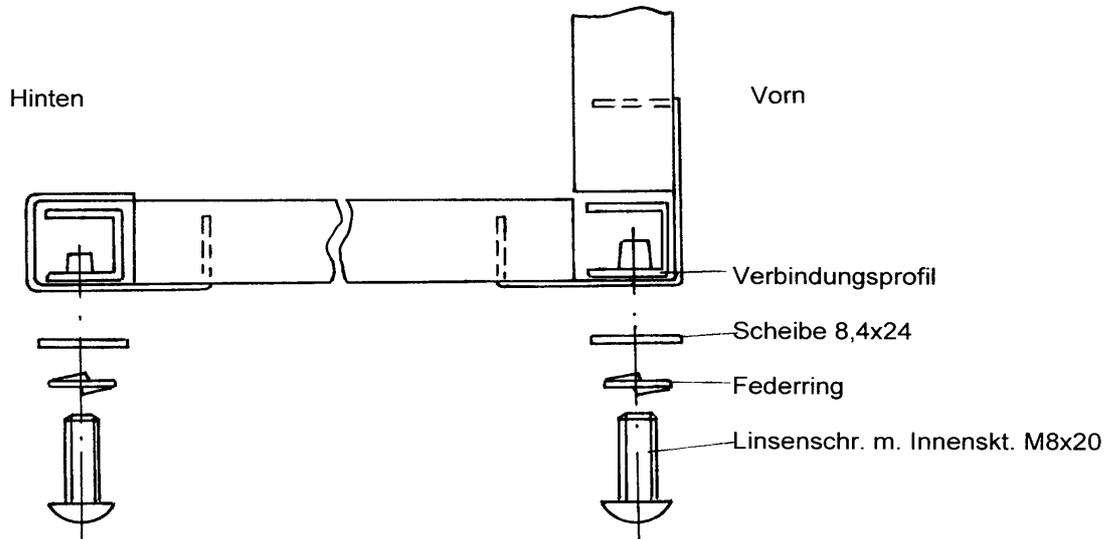
2. Linken und rechten Bordwandaufsatz von oben auf die Verbindungsprofile aufstecken und mit diesen verschrauben.
