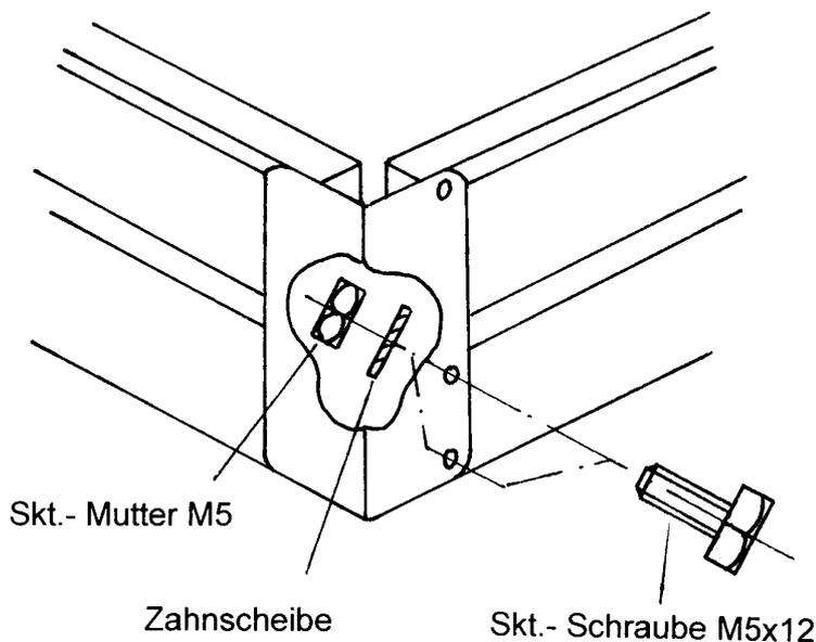
5. Alle Schraubverbindungen festziehen.
