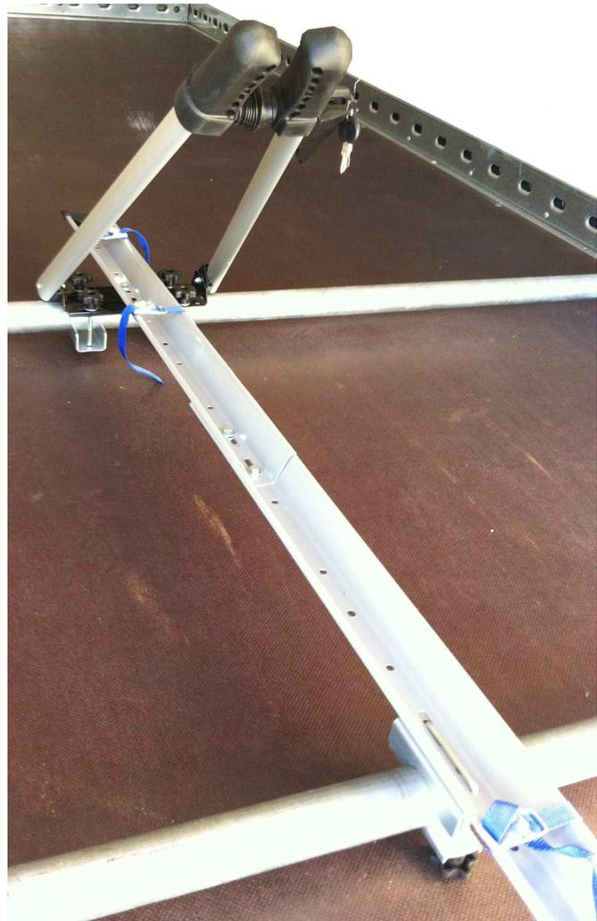
**Hinten: Adapterprofil zwischen Sperrbalken und Radschiene**
