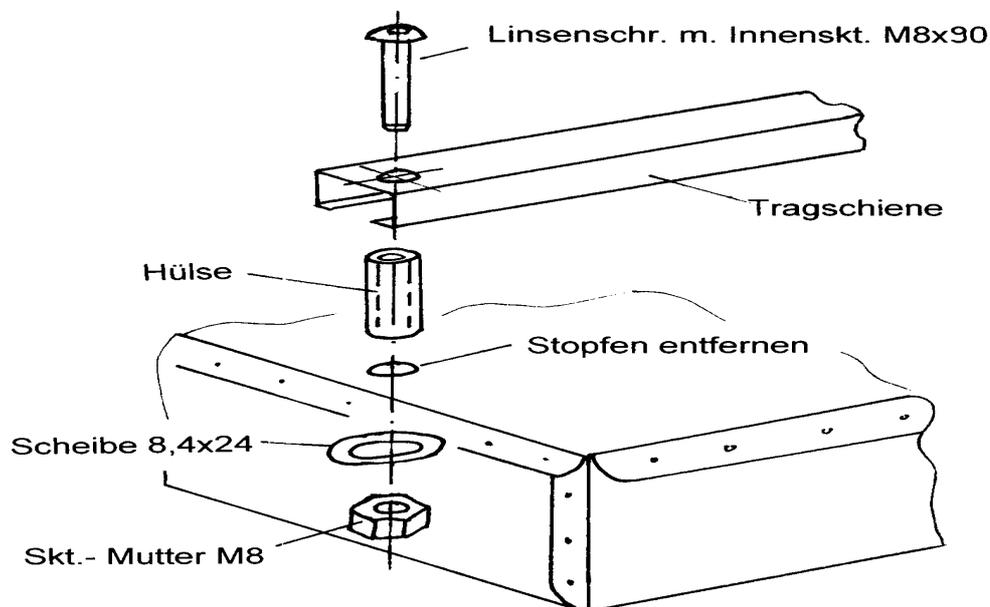
15. **Achtung!** Wurde auf den Bordwänden Ihres Anhängers schon ein Bordwandaufsatz montiert, muss der Anbau der vormontierten Deckelstütze am Bordwandaufsatz, rechte Seitenwand vorn in Fahrtrichtung erfolgen.
