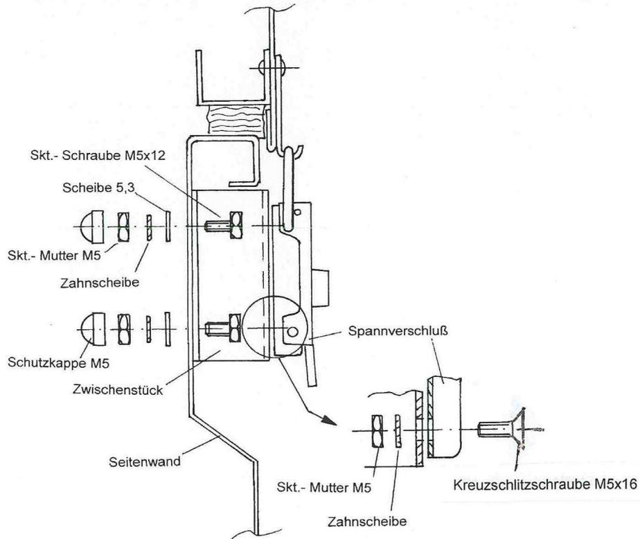
9. Deckel auf Anhänger auflegen, Scharnierober- und Unterteile wie unter Pkt. 7 abgebildet montieren.
