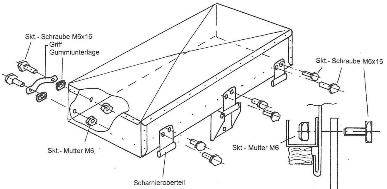
3. Deckel auf Anhänger auflegen und ausrichten, allseitiger Spalt ca. 5 mm.
